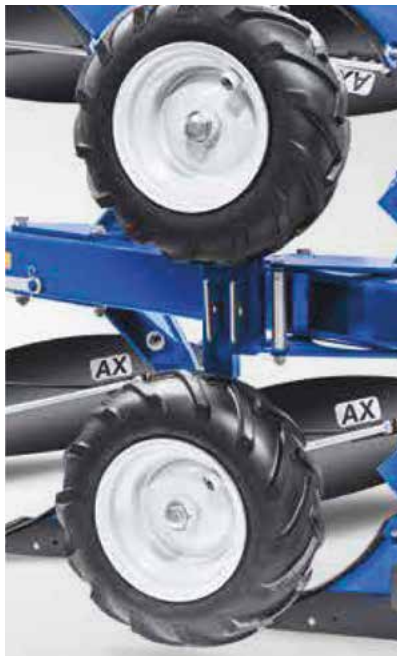
Doppelrad - 23x8.50-12 BX, CX, seitlich montiert
