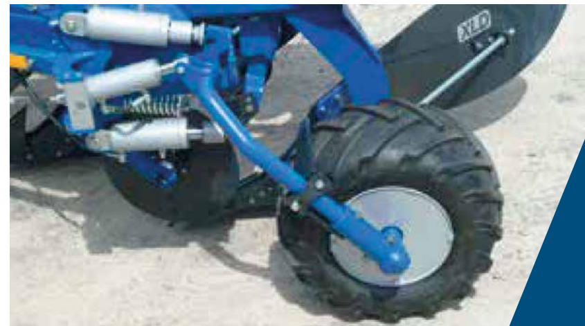
Hydraulische Tiefenregelung und Felgen für die Traktor-Radstütze.
